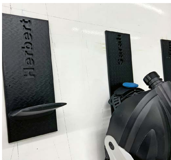
Personalisierte Halterungen für Spritzschutzhauben der Carrosserie Feller, gefertigt mit dem eigenen 3D-Drucker.
