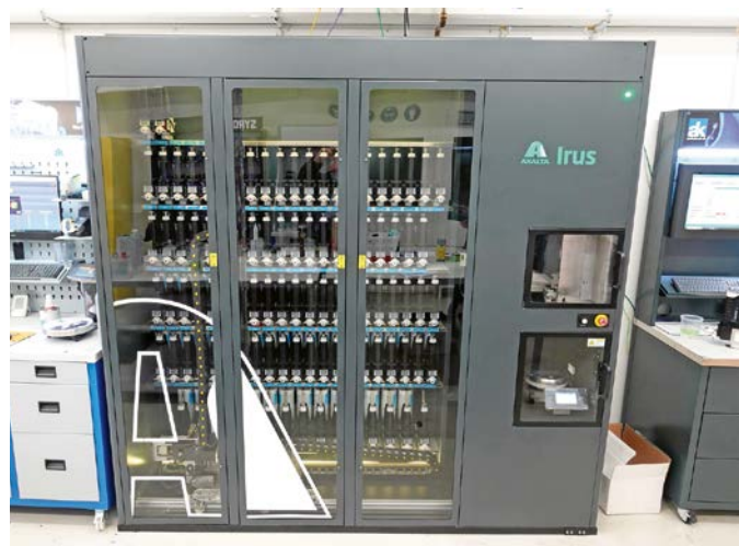
Das vollautomatische Farbmischsystem Irus Mix ist ein wichtiges Element des digitalen Farbtonmanagementprozesses von Axalta.
